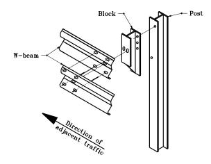
W-BEAM SPLICE CONNECTION DETAIL AT POST
