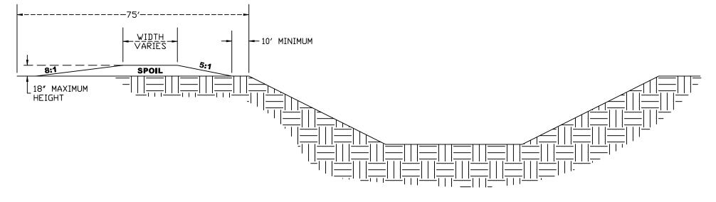
NOTE: 1) SPOIL SPREADING MAY NOT EXTEND BEYOND THE SEVENTY-FIVE FOOT (75') RIGHT-OF-WAY.
